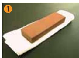
砥石(中砥)の下にぬらした雑巾を敷き、砥石がずれないように固定します。
