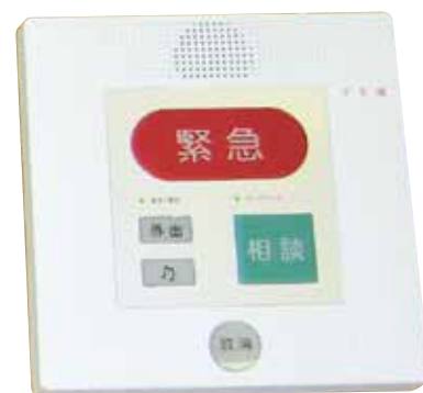
緊急通報システム(実際の写真)
